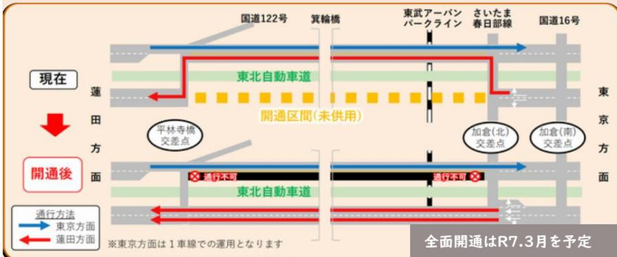
東京から蓮田方面(下り線)『加倉(北)交差点』および『平林寺橋交差点』において、渋滞の原因とされるクランク形状の交差点が解消され2車線での直進が可能となります。また、東京方面(上り)へは引き続き1車線での運用となりますので、渋滞に注意が必要です。
